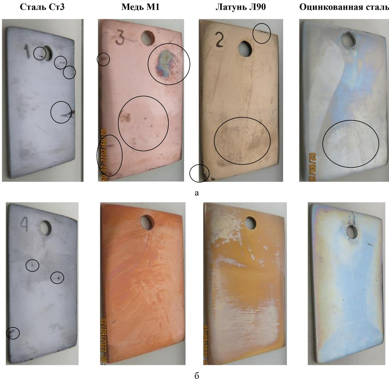
**Рисунок 3.** Внешний вид контрольных образцов металлов (а) и образцов, подвергавшихся КО (б) после 9х месяцев экспозиции на КИС Дам Бай.
