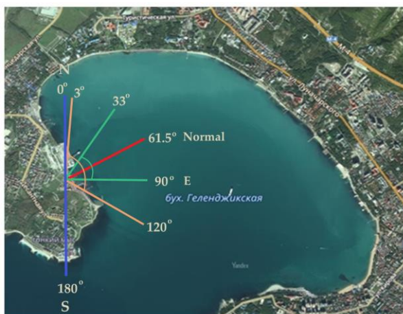
Рисунок 7. Расположение испытательной площадки ГЦКИ на берегу бухты. Интервал ветров морских 3^{\circ} – 120^{\circ} (—) и морских соленых 33^{\circ} – 90^{\circ} (—), нормаль к береговой линии (—).
