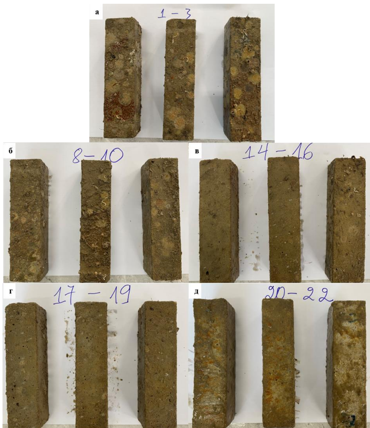
Рисунок 1. Общий вид образцов мелкозернистого бетона с различными МИК после 6 месяцев экспозиции в морской воде: а – контрольный, б – MCI-VN (доб), в – MCI-VN (проп), г – MP80, д – MP85.
