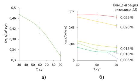
**Рисунок 3.** Зависимость скорости коррозии вольфрама от длительности экспозиции в растворе 3% NaCl при полном погружении: а) без катамина AБ; б) с катамином AБ различной концентрации
