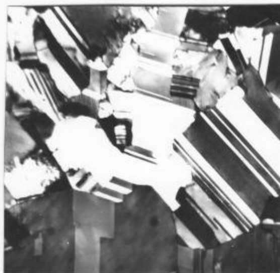
Рисунок 1. Электронная микрофотография осадка меди с дефектами упаковки и двойниковыми границами
