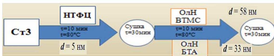
Рисунок 5. Схема двухстадийной обработки водным раствором ингибиторов коррозии Ст 3 и толщин тонких адсорбционных покрытий.
