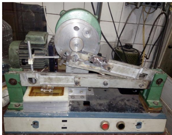
Рисунок 3. Установка для циклического нагружения образцов методом четырёхточечного изгиба.
