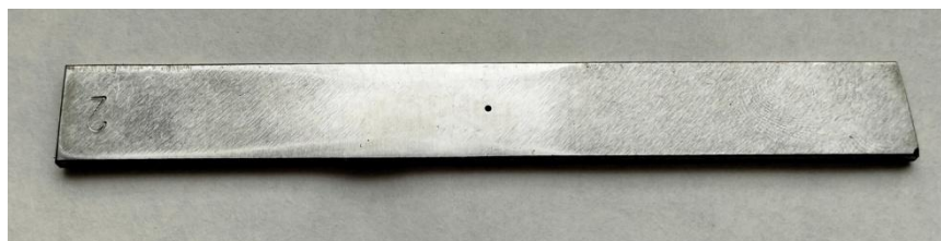
Рисунок 4. Образец для проведения коррозионно-механических испытаний методом четырёхточечного изгиба образца.
