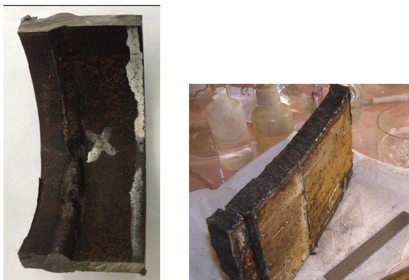
Рисунок 1. Примеры фрагментов металлического материала, вырезанного из стенки трубы, из которого изготавливали образцы для исследований.
