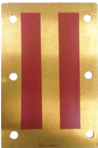
**Рисунок 4.** Образец с нанесенным покрытием. Слева–стандартное покрытие P-8595TT, справа-модифицированное покрытие с 1% МК ОДЭФК.
