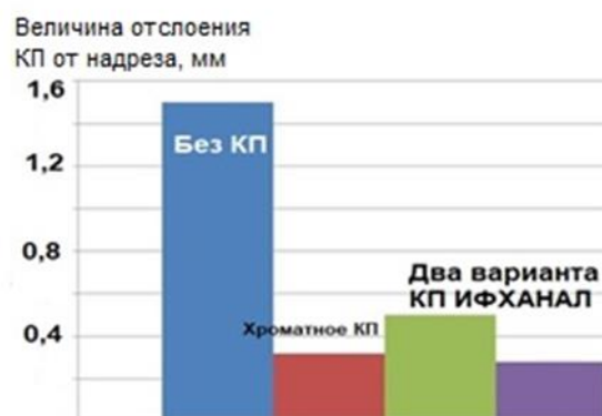
Рисунок 3. Результаты испытания алюминиевых сплавов в КСТ без и с КП (хроматное или ИФХАНАЛ-3) при последующей порошковой окраске и нанесением надреза покрытия.
