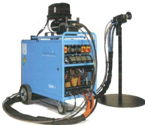
Рисунок 1. Внешний вид установки электродуговой металлизации ТСЗП-ЭДМ-350.
