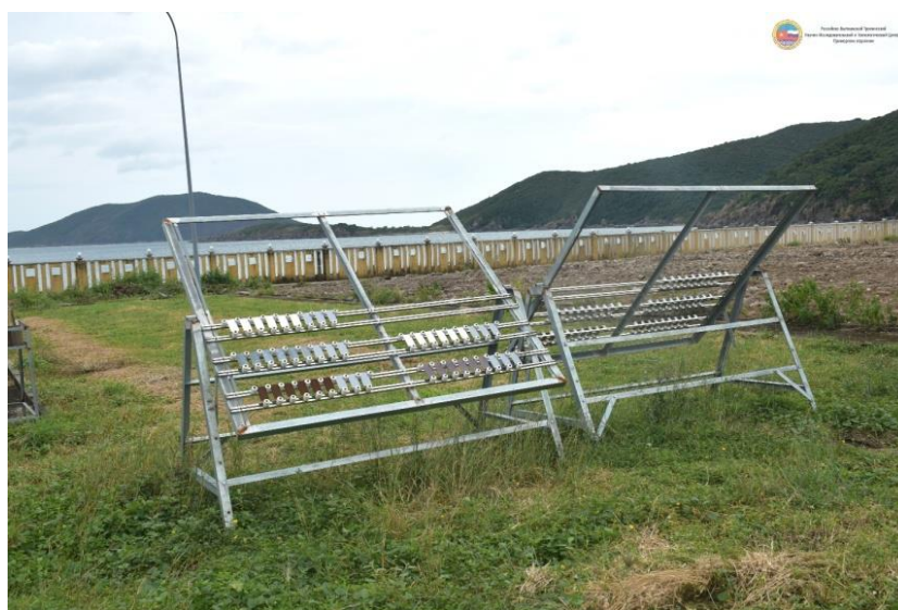
Рисунок 4. Дам Бай. Расположение на стендах образцов верхней стороной от моря и к морю.
