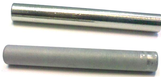
Рисунок 1. Внешний вид образцов никеля НП2 без покрытия (сверху) и с покрытием (снизу)
