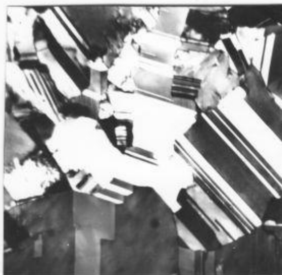
Рисунок 1. Электронная микрофотография осадка меди с дефектами упаковки и двойниковыми границами
