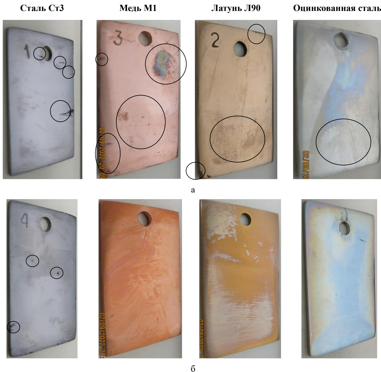
Рисунок 3. Внешний вид контрольных образцов металлов (а) и образцов, подвергавшихся КО (б) после 9х месяцев экспозиции на КИС Дам Бай.
