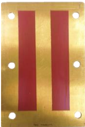
Рисунок 4. Образец с нанесенным покрытием. Слева – стандартное покрытие Р-8595ТТ, справа – модифицированное покрытие с 1% МК ОДЭФК.
