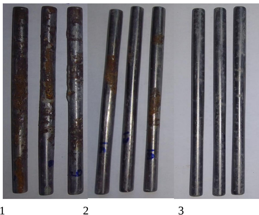
Рисунок 3. Внешний вид арматурных стержней после 44 месяцев экспозиции образцов с 3% хлорида натрия в тропиках. 1 – образцы, не содержащие ингибитора, 2 – образцы, содержащие 1,5% ингибитора, 3 – образцы, содержащие 3% ингибитора.
