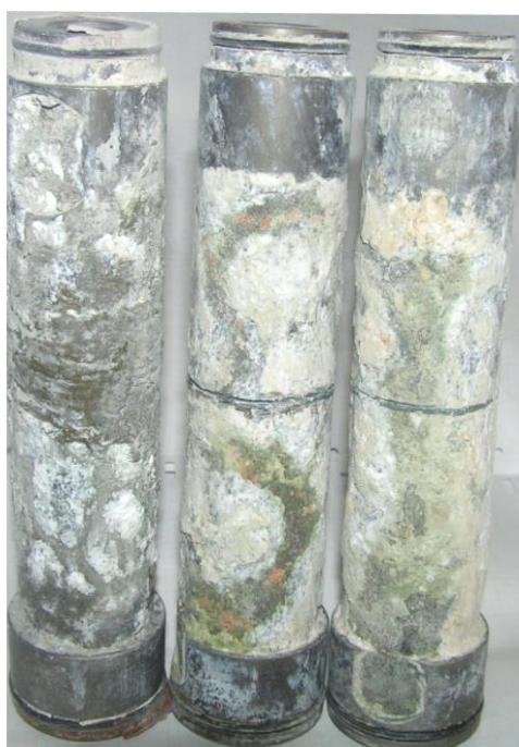
Рисунок 1. Внешний вид алюминиевых втулок литейных машин после 2-х лет эксплуатации.
