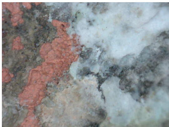
Рисунок 2. Микрофотографии поверхности алюминиевой втулки литьевых машин до (а) и после (б) удаления продуктов коррозии (х 20).
