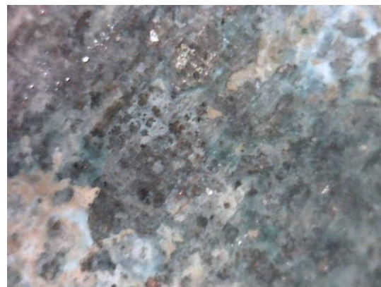
Рисунок 2. Микрофотографии поверхности алюминиевой втулки литьевых машин до (а) и после (б) удаления продуктов коррозии (х 20).
