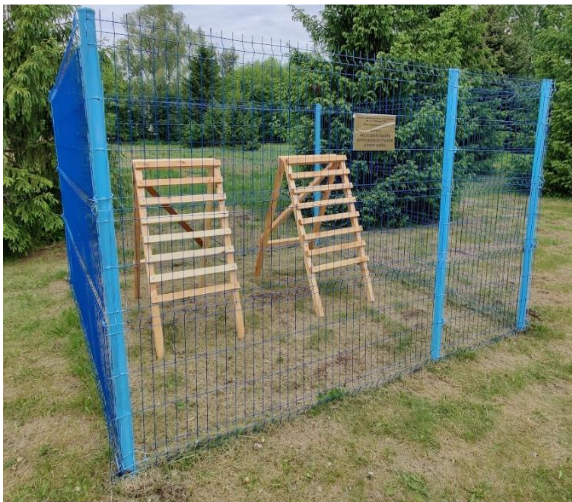
Рисунок 1. Коррозионная станция «Старая Майна»
